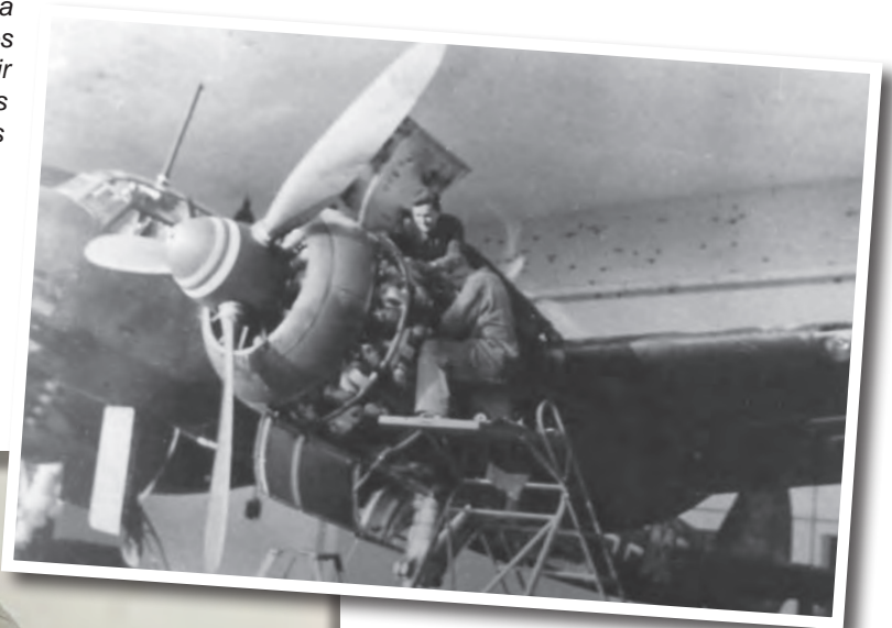
Entretien d'un moteur BMW 801 d'un Ju 88 S-1 à Melsbroek par les Ogfr. Ottmar Joseph et Uffz. Otto Beister.
